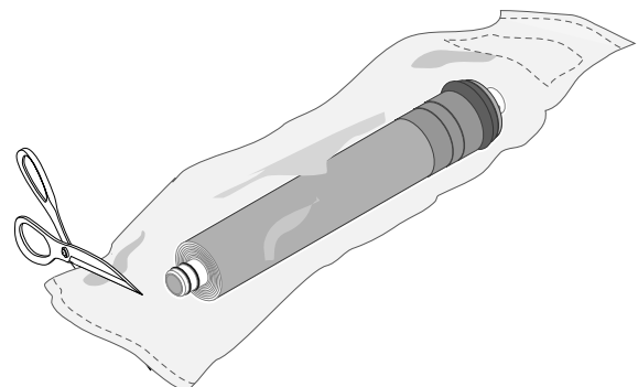
Figure 8 : Couper le sac de la membrane du côté où la membrane est munie de 2 joints toriques. Ne pas endommager la membrane ni la toucher !
